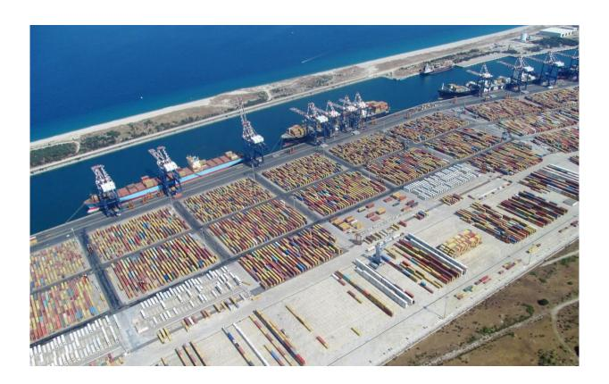
L'area adiacente il bacino di evoluzione nord ospita il **Terminal Auto, in concessione alla società ICO BLG Italia S.p.A.** con una superficie di piazzali per la movimentazione, stoccaggio e distribuzione di veicoli ed annesse lavorazioni di circa 270.000 mq. Il Terminal è dotato, inoltre, di un centro tecnico (PDI) attrezzato per l'erogazione di servizi a valore aggiunto (lavaggio/deceratura e ceratura, installazione di parti accessorie, interventi di verniciatura e riparazione danni).
